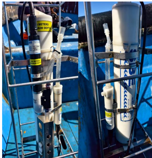
Figura 4 Equipo CTD Seabird® 19 empleado para el estudio de la salinidad y temperatura en la columna de agua.
