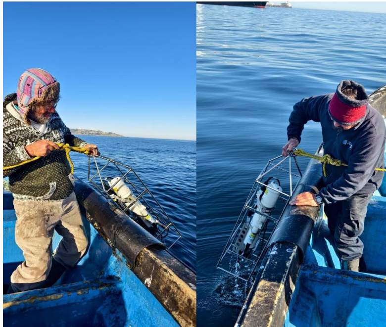
Figura 2 Despliegue de CTD en dos puntos de monitoreo con apoyo de integrantes de la Federación de pescadores y la academia.
