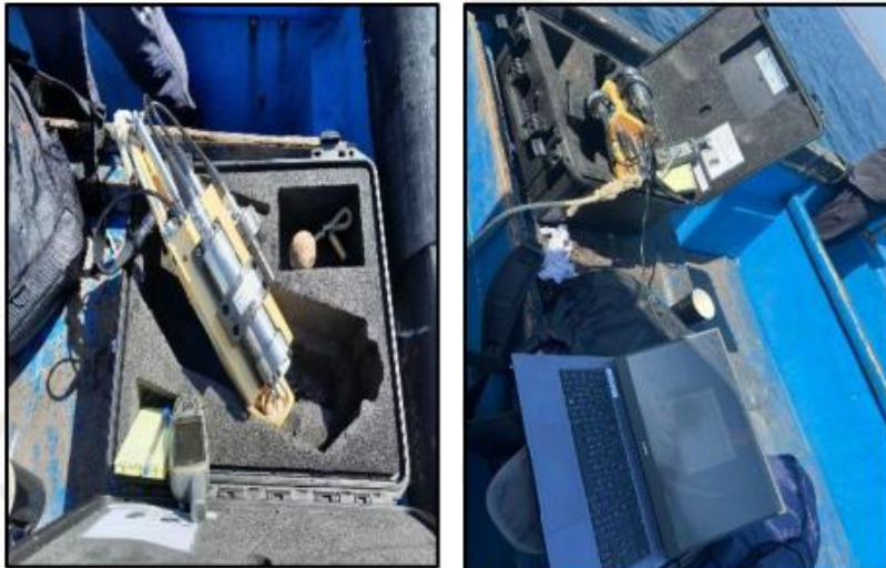
Figura 4 Equipo CTD SD204 empleado para el estudio de la salinidad y temperatura en la columna de agua.
