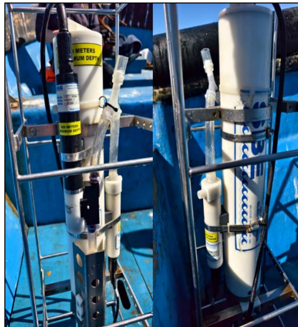
Figura 1. Instrumento CTD modelo SBE19 Plus V2 SeaCAT empleado para el monitoreo de la salinidad y temperatura en la columna de agua.
